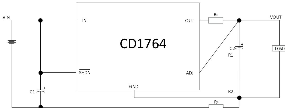
ADJ (5 脚) : 可调端。可调输出版本的产品具备该端口, ADJ 端直接连接到内部运放的反向输入端口。该端口的内部嵌位电压为  $\pm 7V$ 。该端口的偏置电流约为 3uA, 电流方向为流入器件。ADJ 端电压约为 1.2V, 输出电压调整范围为 1.2V 到 20V。
